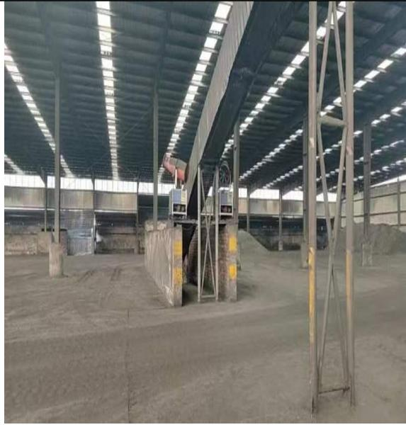
图2-5 封闭式输煤皮带+雾炮机
