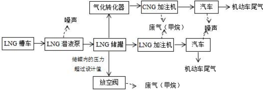
图 2-8 LNG 天然气加气站工艺
