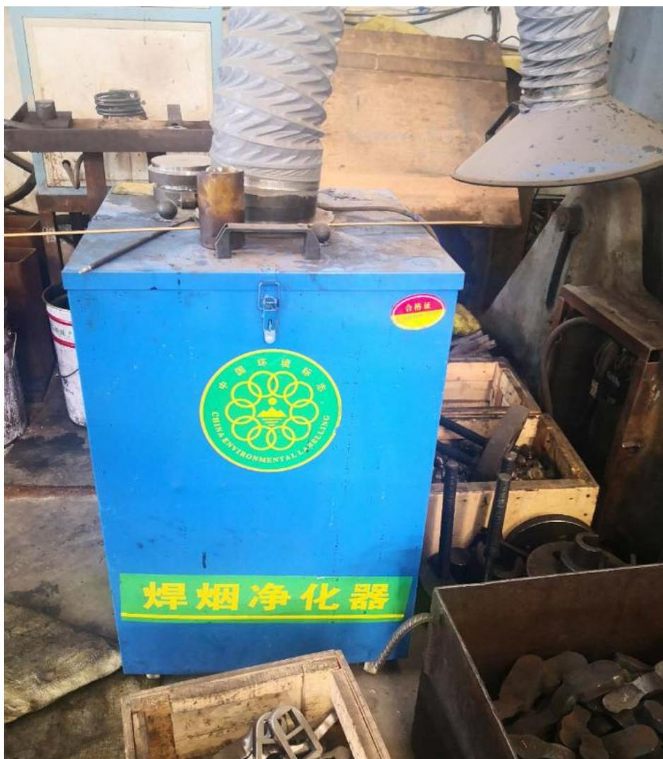
图 3-1 焊烟净化器（移动式）
