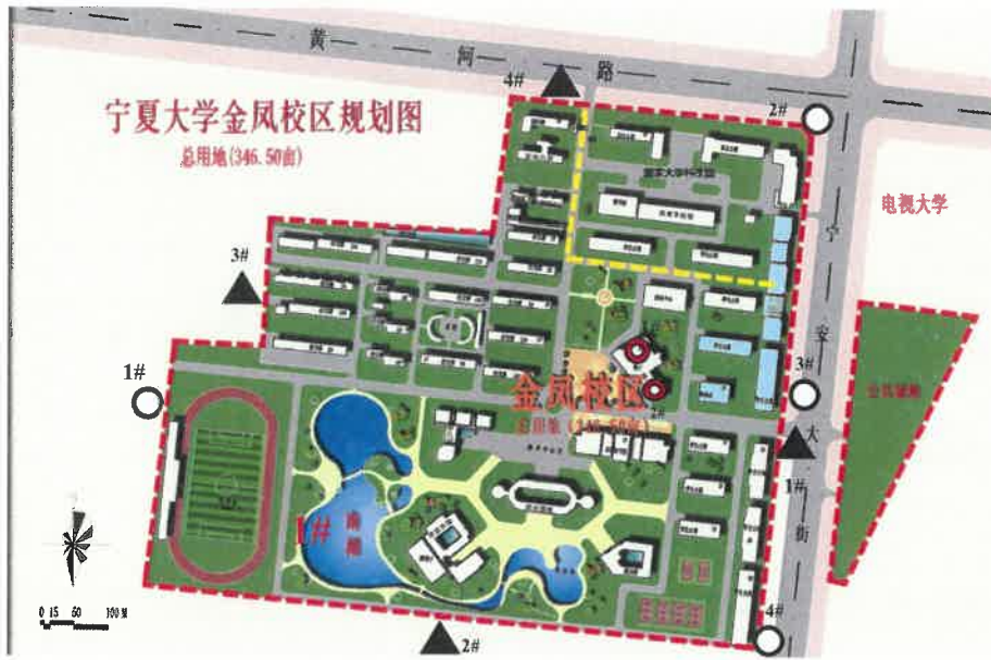
注：图中“◎”表示有组织废气检测点位，“○”代表无组织废气检测点位，“▲”代表噪声检测点位
